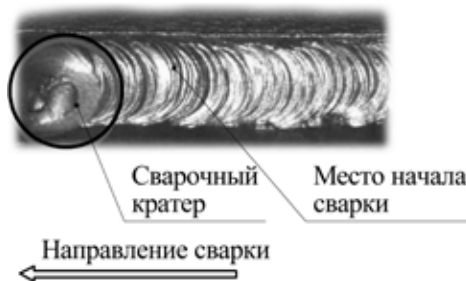
Рис. 10.4. Начало сварки при смене электрода.
